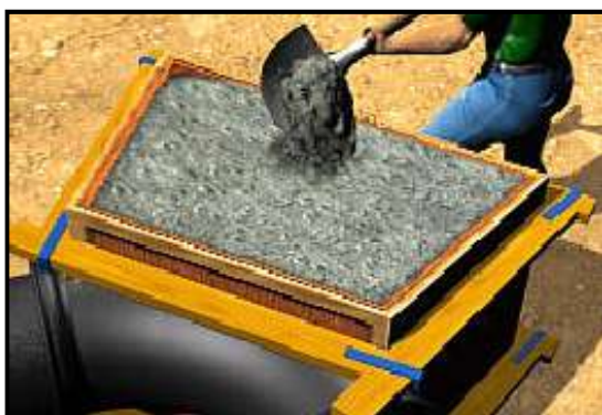
Figura 5 - Concretagem do bloco (a)
